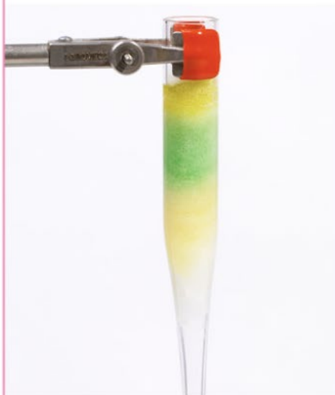
FIG. 8 Séparation des constituants d'un mélange (extrait de feuilles d'épinards) par chromatographie sur colonne de silice.
